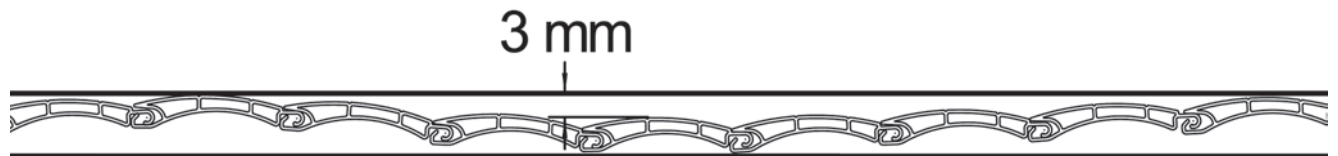
Bild 5 Messung der Welligkeit (mit Lineal!)
