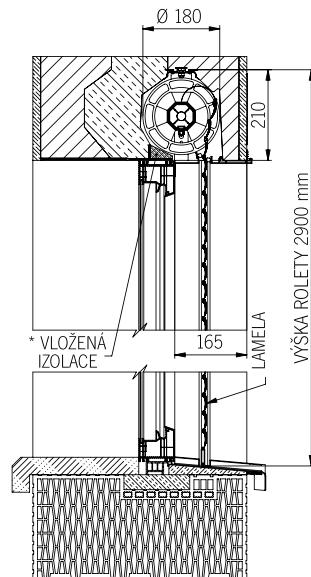
\* upravené vložená izolace pro osazení okna ve vzdálenosti 165 mm pro průměr balu 180 mm.
